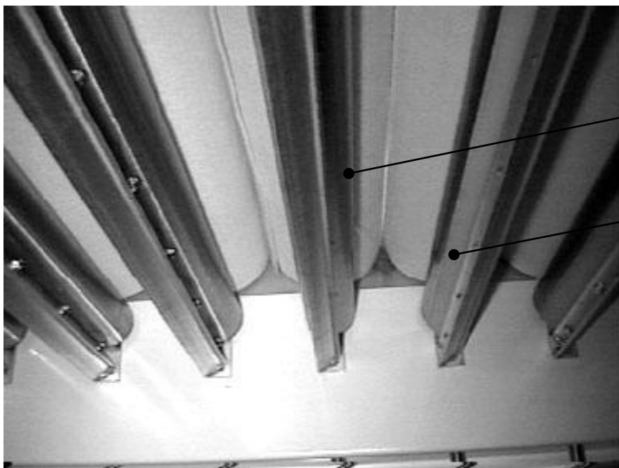
Рис.4 Отжимной ролик со скребком (вид снизу)
